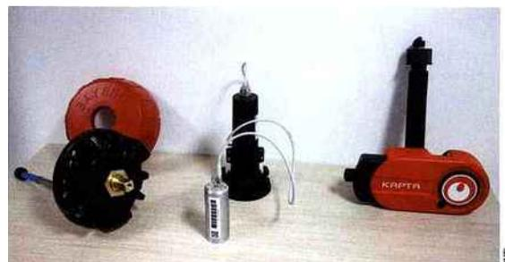
**Un millier de détecteurs corrélants Gutermann seront installés d'ici fin 2016, ainsi que 30 sondes Kapta pour le suivi en temps réel de la qualité (température, pression, conductivité-salinité, chlore), et des détecteurs de vol d'eau (Bayard) pour les équipements de lutte contre les incendies.**
