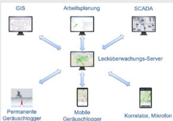
Bild 9: Vernetzte IT-Infrastruktur für eine effiziente Lecküberwachung
