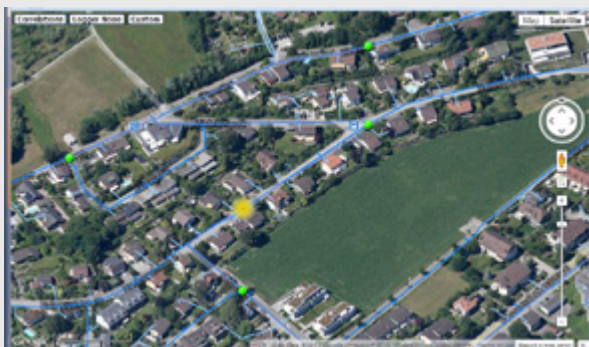
Bild 6: Beispiel eines kleinen Lecks, das nur durch Korrelation (gelber Punkt) detektiert wird. Die Geräuschpegelmessung der Logger zeigt kein Leck an (grüne Punkte)
