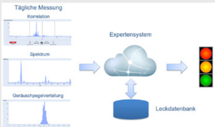
Bild 4: Expertensystem zur Bestimmung der Leckwahrscheinlichkeit
