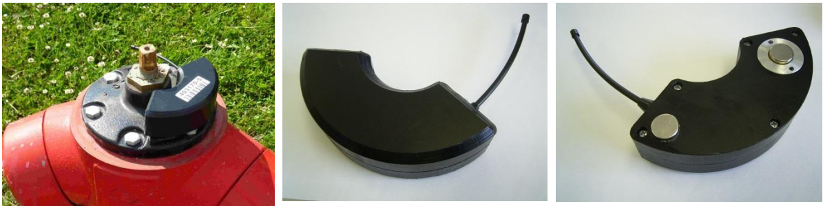
Figura 1.5 Fotos de un logger acústico desarrollado para encajar sobre hidrantes superficiales
