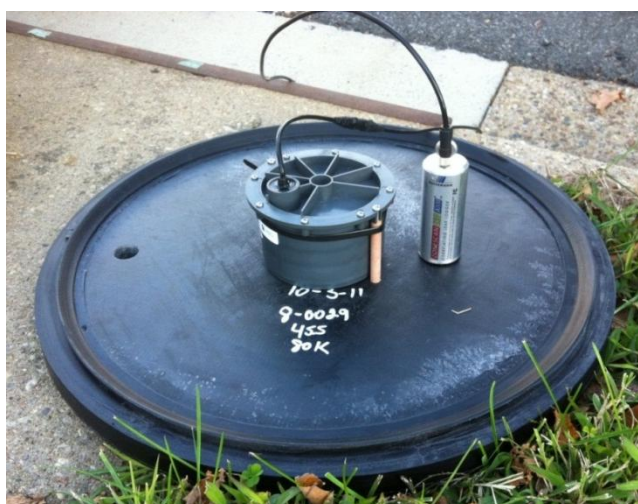
Figura 2.1 Logger acústico modificado para transmitir resultados de una red fija de monitores de medidores
